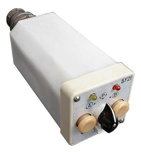
Блок управления релейного регулятора БУ21 предназначен для ручного переключения управления нагрузкой релейного регулирующего блока с автоматического "А" на ручное "Р" или внешнее "В" и для коммутации цепей ручного управления.
